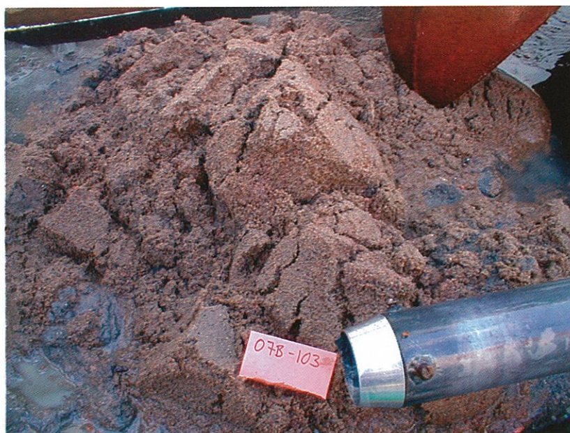
Fig. 11. Prov 07B-103 från sandav- lagringen norr om Dösebacka. Sandavlagringen består här av postglacial grovsandig mellan- sand. Foto Fredrik Klingberg.
