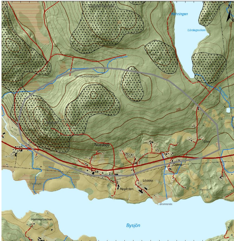
Figur 3. Exempel på terrängskuggning baserad på nationella höjdmodellen (solvinkel 315° och solhöjd 45°) som framtagits för att underlätta identifiering av områden med raviner och spår av skred, ras samt slamströmmar.
