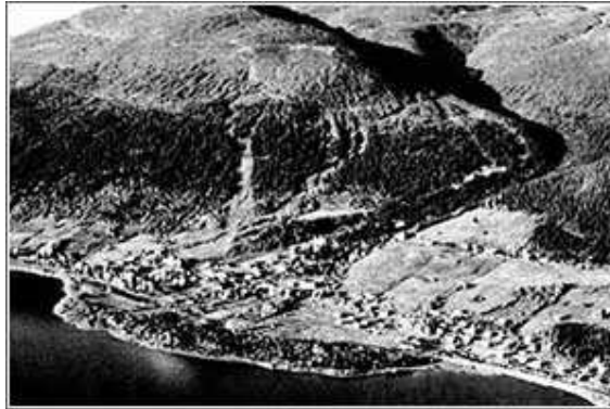
Figur 6-3 Åre samhälle ligger på avlagringar av grus och sand från ett stort antal skred och ras och efterföljande slamströmmar som inträffat sedan istiden längs Mörviksåns ravin. Foto: J Lundqvist, SGU 1962
