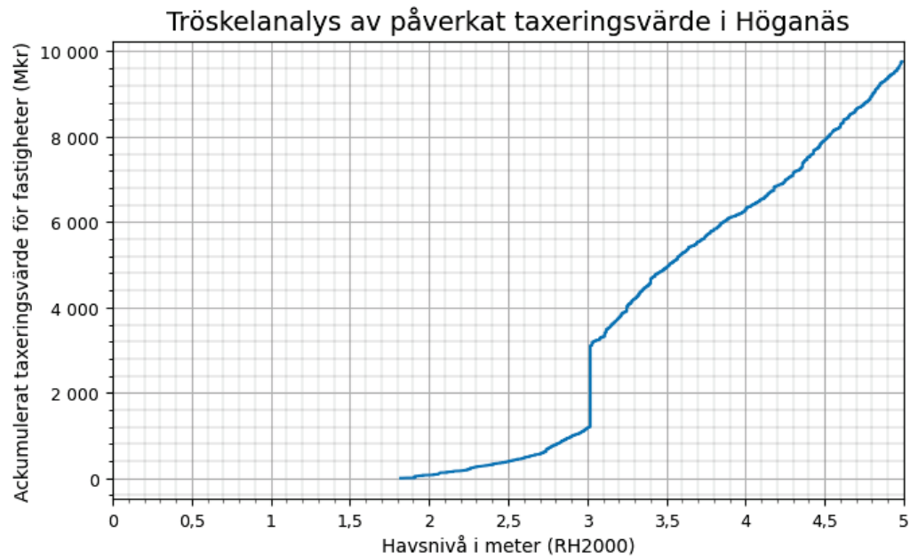
Figur 10 Det ackumulerade taxerade värdet (år 2023) för bostäder i Höganäs kommun som riskerar att översvämmas vid havsnivåer mellan 0-5 m. Taxeringsvärdet inkluderar både tomtvärde och byggnadsvärde.
