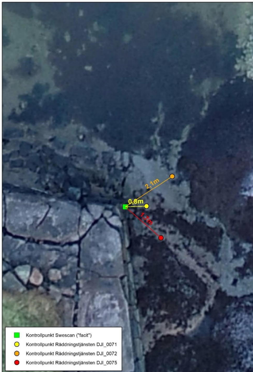
Figur 8 Läge hos en kontrollpunkt (hörnet på muren) i ortomosaik från professionell flygning, jämfört med motsvarande läge för murens hörn i ortomosaik från testflygningar. Spridningstillstånd drönardata Dnr LM2020/003327.
